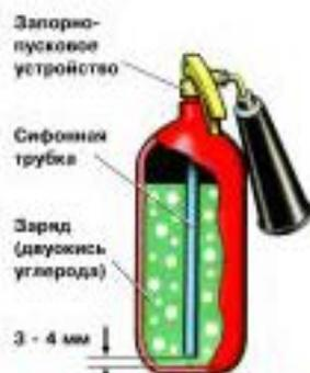
**ПРИНЦИП ДЕЙСТВИЯ** основан на вытеснении двуокиси углерода избыточным давлением. При открывании запорно-пускового устройства  $CO_2$  по сифонной трубке поступает к раструбу и из сжатого состояния переходит в твердое (снегообразное). Температура резко (до  $-70^{\circ}C$ ) понижается. Углекислота, попадая на горячее вещество, изолирует его от кислорода.
